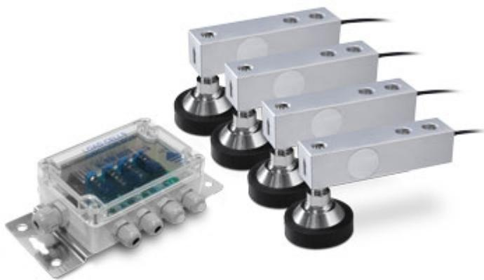
Ideato per realizzare piattaforme a 4 celle di carico di varie misure e capacità. Il kit è composto da 4 celle di carico da 350 Ohm, omologate OIML e NTEP, in acciaio nichelato IP67, complete di piedini di appoggio regolabili e scatola di equalizzazione.
